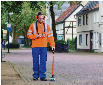
SeCorrPhon AC 200 ile nokta tespiti
