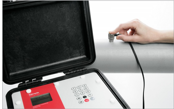
Duvar kalınlığı ölçer NT ve KATflow 210 kullanımda
